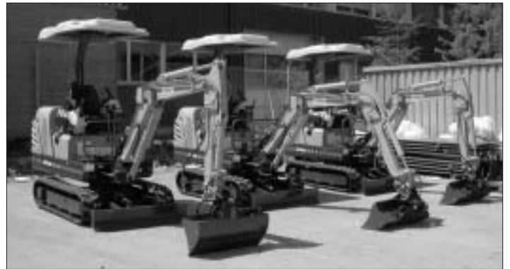
Drei neue Kleinbagger für den Einsatz auf kleinräumigen engen Baustellen
