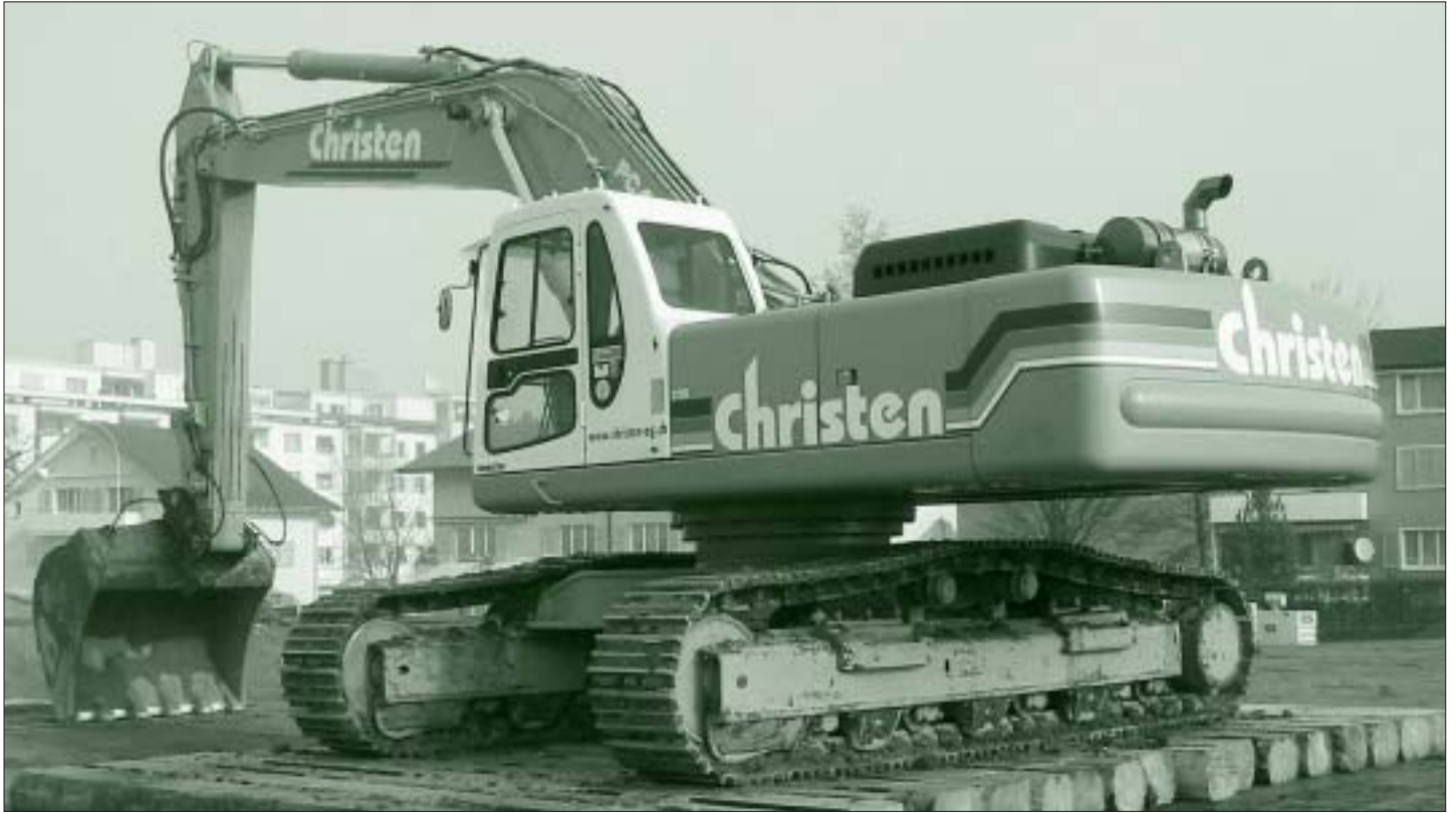
Der neue, leistungsfähige Hydraulik-Bagger (Komatsu) wiegt 50 Tonnen, hat vier auswechselbare Werkzeuge und schont die Umwelt (dank Katalysator und Russpartikelfilter)
